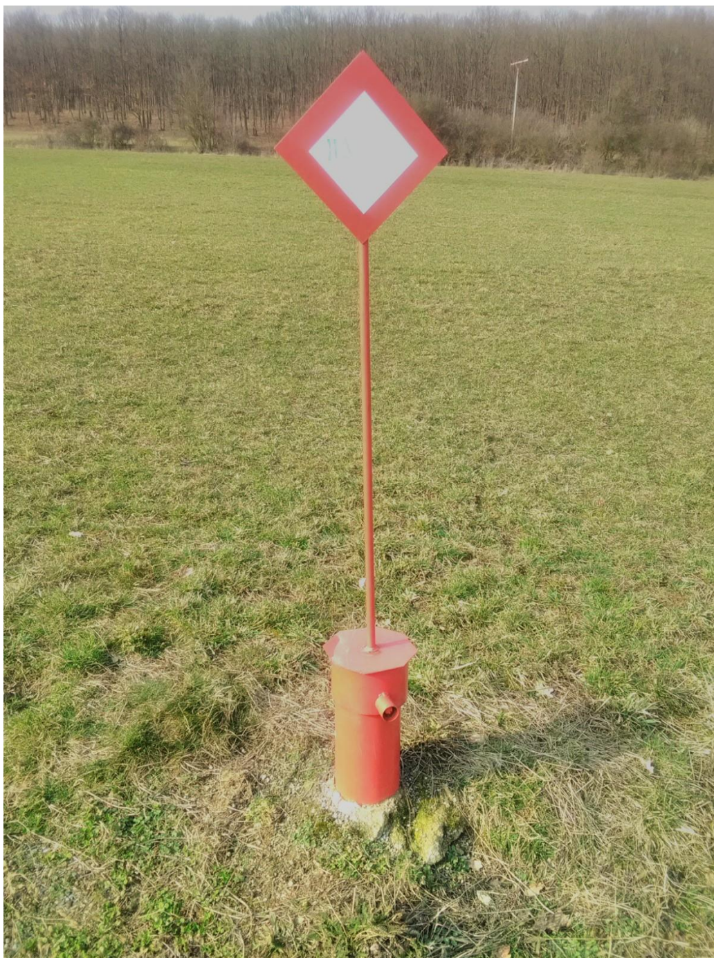
Obr. 4: Vrt u budoucího tunelu.
